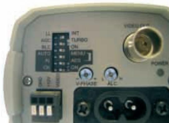
Il BLC è un'importante elaborazione elettronica che ci consente di compensare il controllo (Back Light Compensation).
